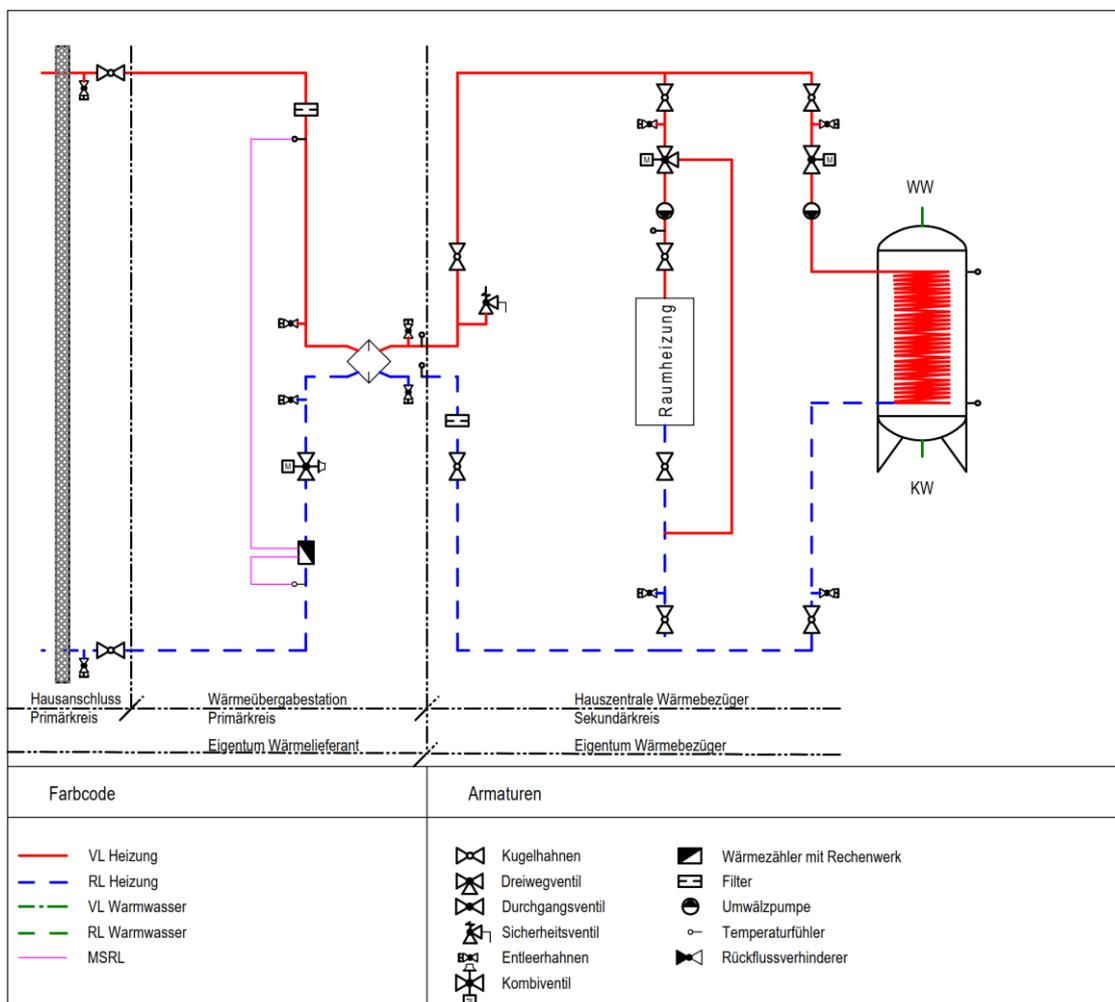
Für die Einbindung in das sekundärseitige Fernwärmenetz sind Boiler/Warmwassermodule oder Pufferspeicher zugelassen welche eine max. primäre Rücklauftemperatur von 50°C nicht überschreiten.
