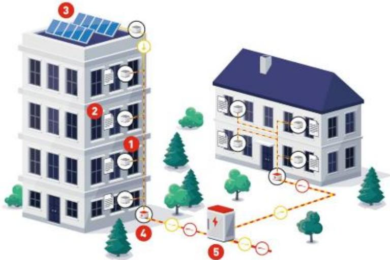
1) Smart-Meter, 2) Stromrechnung Endverbraucher, 3) PV-Anlage, 4) Hausanschluss, 5) Verknüpfungspunkt, z.B. VK
