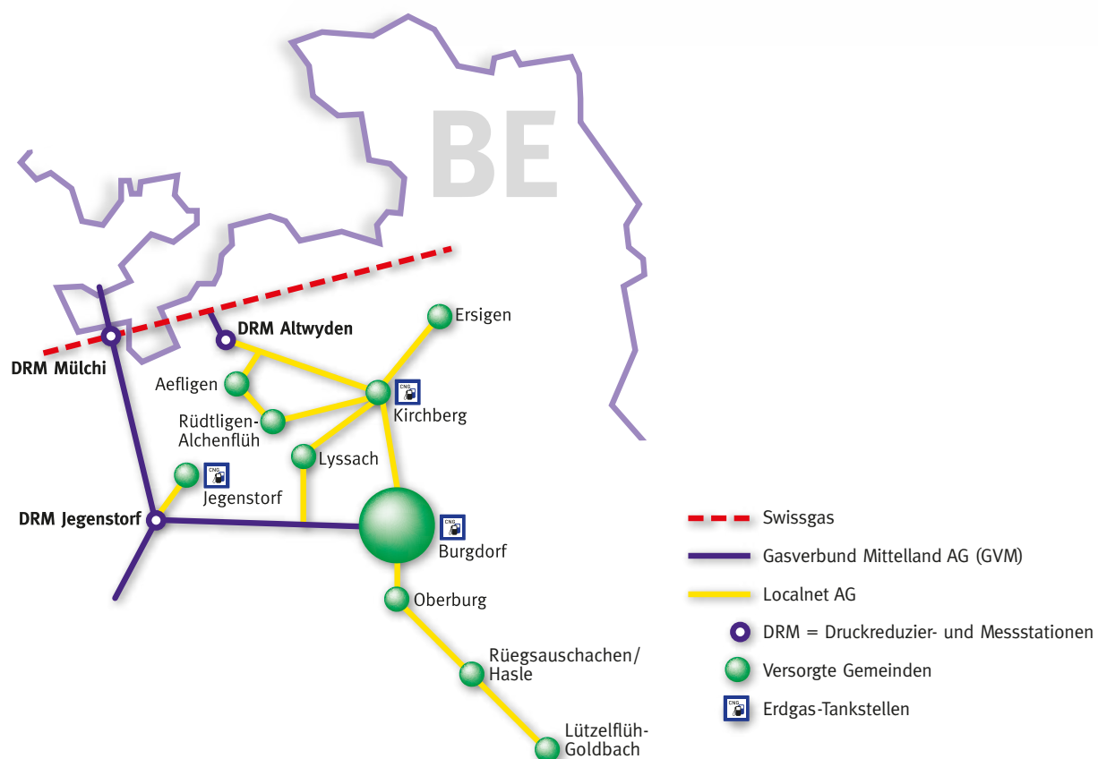
Schema der Erdgasversorgung der Region Burgdorf
